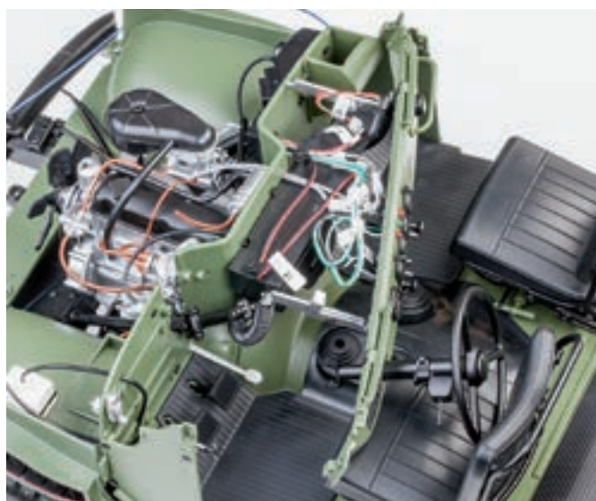
Шаг 19. Двумя винтами 1,7×4 (СМ) закрепите вставку перегородки моторного отсека над валом рулевого управления.
