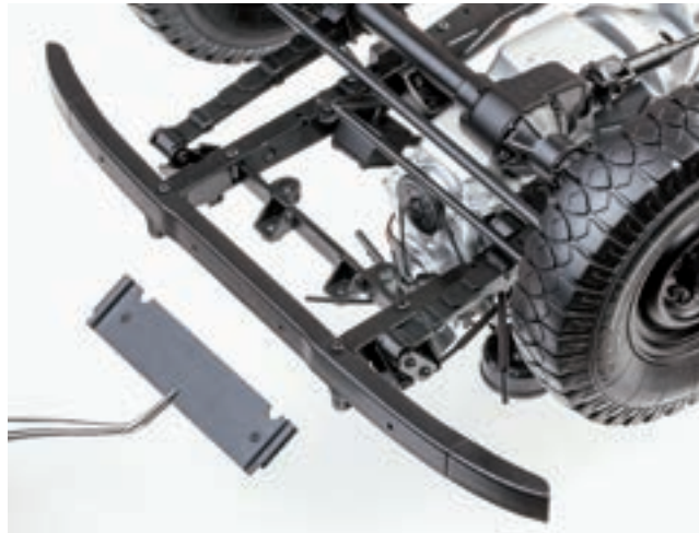
Шаг 8. С нижней стороны рамы установите накладку поперечины рамы. Совместите крепежные отверстия деталей и закрепите накладку двумя винтами 2,0×5 (IP) с верхней стороны рамы.
