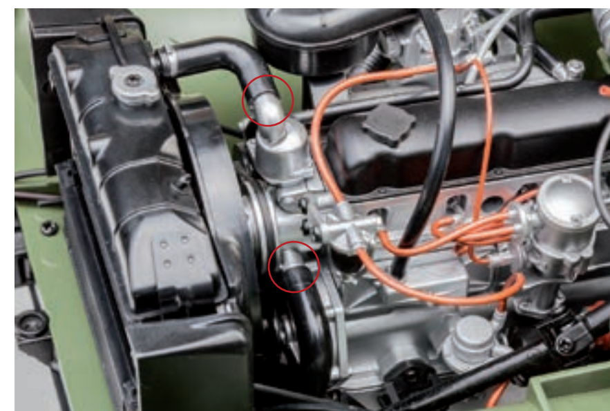
Шаг 23. Установите радиатор на перемычку кузова и закрепите его с нижней стороны рамы. При установке обратите внимание на положение верхнего и нижнего шлангов радиатора, а также на крыльчатку вентилятора.
