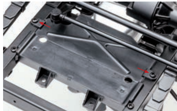
Шаг 9. Позади накладки разместите передний брызговик двигателя. Закрепите деталь на раме двумя винтами 2,3×5 (IM).
