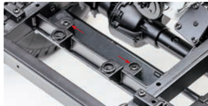
Шаг 8. С нижней стороны рамы установите накладку поперечины рамы. Совместите крепежные отверстия деталей и закрепите накладку двумя винтами 2,0×5 (IP) с верхней стороны рамы.
