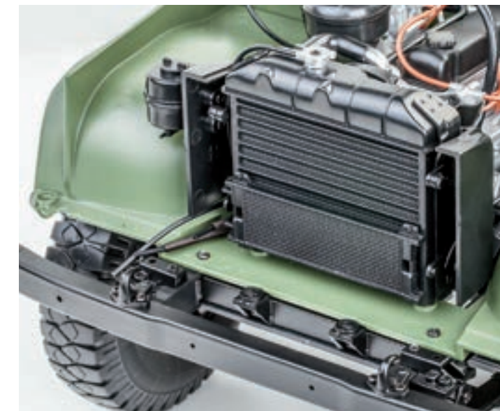
Шаг 23. Установите радиатор на перемычку кузова и закрепите его с нижней стороны рамы. При установке обратите внимание на положение верхнего и нижнего шлангов радиатора, а также на крыльчатку вентилятора.
