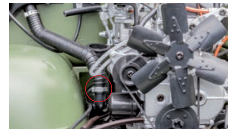
Шаг 13. Закрепите воздушный патрубок отопителя на корпусе котла предпускового обогревателя.
