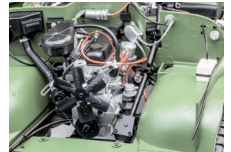
Шаг 12. Установите кузов поверх шасси. При монтаже обращайте внимание на детали моторного отсека, установленные на раме: трубки к масляному радиатору, элементы управления карбюратором, топливные трубки и детали рулевого управления. В задней части необходимо протянуть провод к розетке прицепа между полом кузова и рамой.
