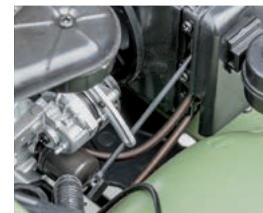
Шаг 25. Протяните верхний и нижний шланги масляного радиатора между корпусом радиатора и правым кожухом. Закрепите шланги на выводных патрубках масляного радиатора. При необходимости укоротите шланги и защитные пружины.
